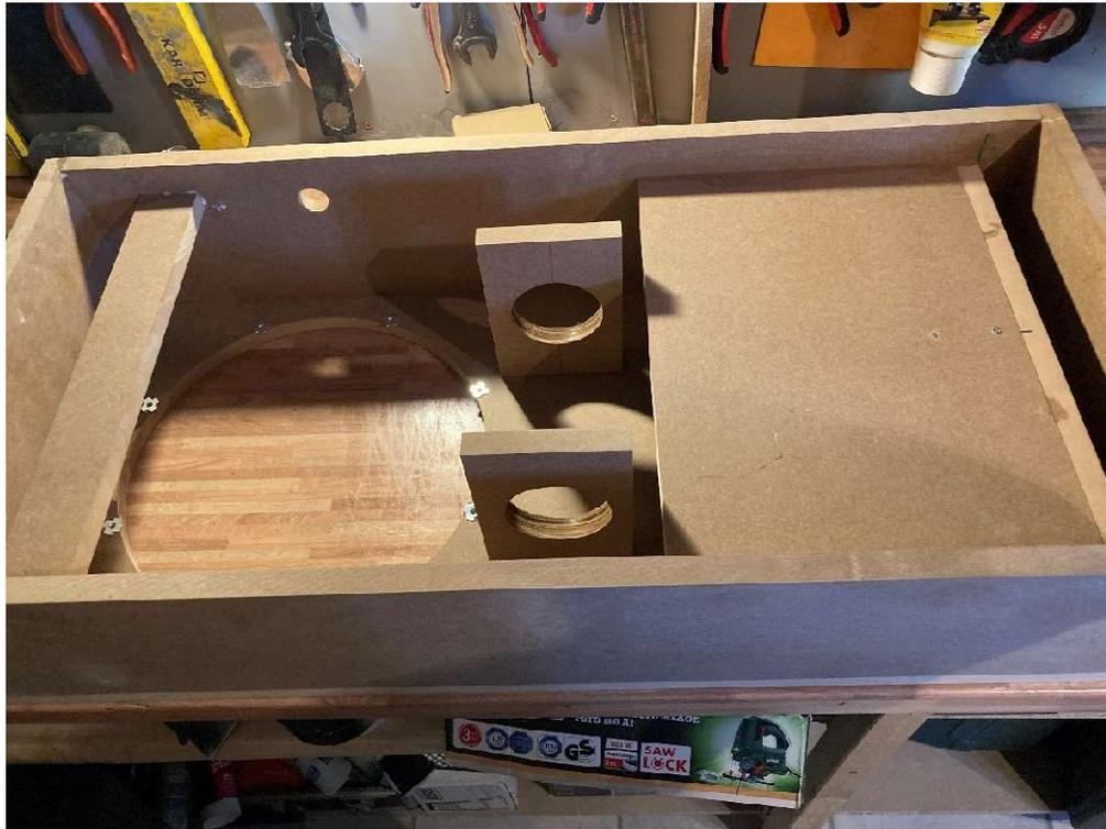
Die Öffnung des BR Kanals an der Front schneidet man mit der Stichsäge etwas vor und fräht den Rest mittels Bündigfräser damit man eine schöne Kante hat.
