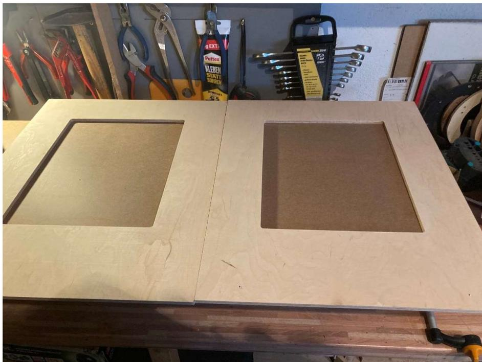
Nun wird anschließend aus der Aufdopplung die Aussparung für das Waveguide geschnitten. Dies kann gefräst oder auch mit der Stichsäge und einer ruhigen Hand ausgesägt werden.
