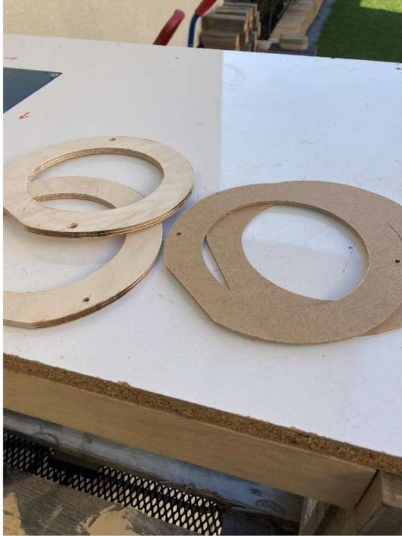
Auf die 6,5mm MPX Platte legt man nun den Beyma MT und bohrt von hinten die Befestigungslöcher durch. Die 3mm MDF/HDF Platte legt man auf die MPX Platte und zeichnet die Löcher mit einem Filzstift an.
