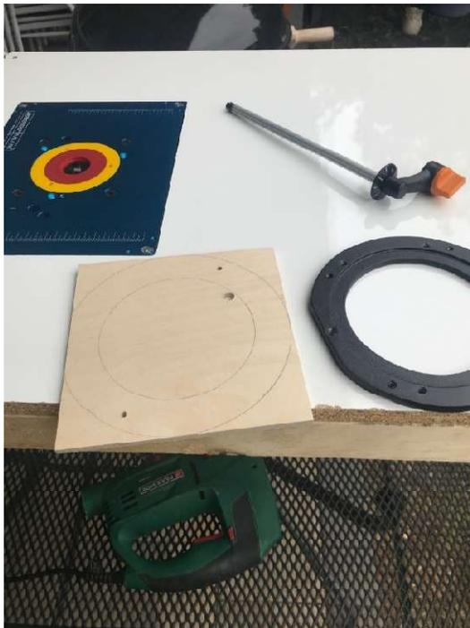
In den mittleren Ring nahe dem auszufräsenden Ring ein Loch bohren, um mittels einer Stichsäge nahe am Rand vorzuschneiden.
