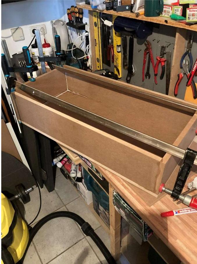
Als nächstes habe ich die Verstrebungen bearbeitet mit einem Lochkreisbohrer da diese als Stabilisierung des BR Kanals dient.
